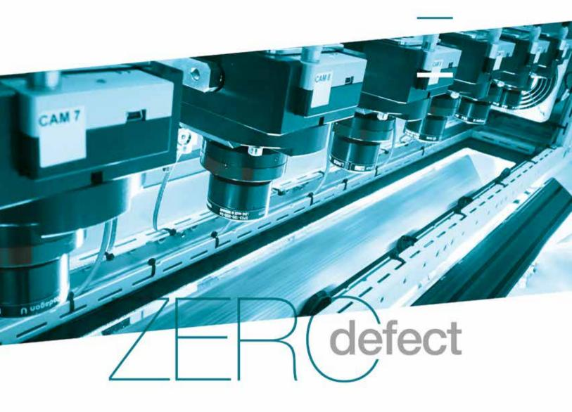
ON-LINE AUTOMATIC SURFACE INSPECTION & MEASUREMENTS
